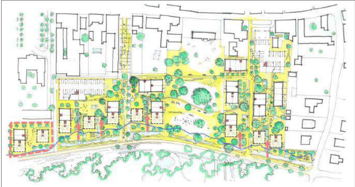
Figure 9 : Evolution du plan de masse : aucun bâtiment dans la zone d'expansion de crues (source Schurdi-Levraud architecture / visuel non contractuel)
