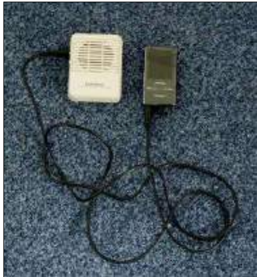
Matériel de repasse : lecteur MP3 raccordé à une enceinte portable par un câble « jack ».
