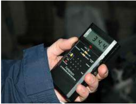
Détecteurs de type Pettersson Elektronik D240x
